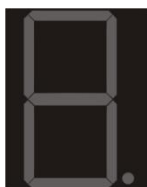
Rys. 4.10.1. Znak spacji (kod ASCII = 40h)
