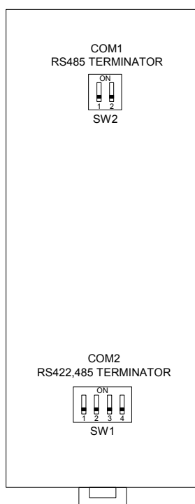
Rys. 2.6 Widok złąc konwertera TRU-5321 od tyłu
